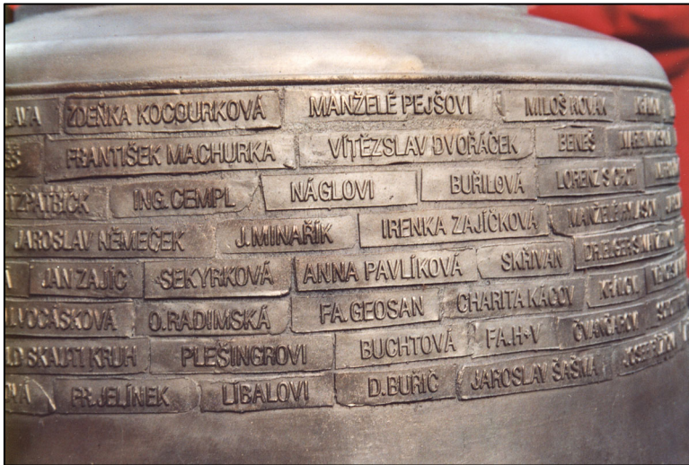
Zvon Jan a Pavel před zavěšením na zvonici. Hmotnost 850 kg, průměr 114 cm, tón Fis 1. Výzdoba pláště zvonu od akademického sochaře Jaroslava Hylase. Po obvodu zvonu jsou pod jeho korunou odlita jména všech dárců, kteří na jeho výrobu přispěli. Spolu s břevnem, elektrickým pohonem a elektronickou řídicí jednotkou stál zhruba 400 tisíc korun českých, které byly vybrány ve farní sbírce
