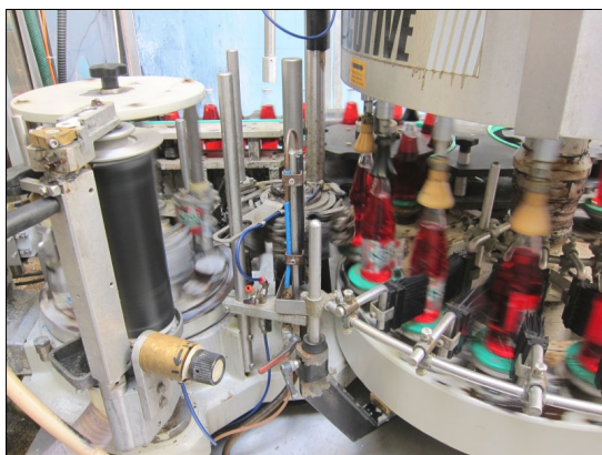
Kamerový způsob kontroly čistoty skleněných láhví s LED podsvícením
