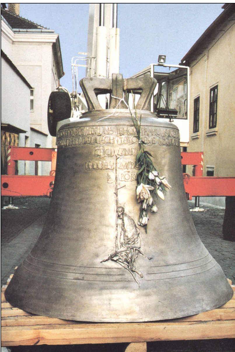
Zvon Bartoloměj před zavěšením na zvonici. Hmotnost 2 145 kg, průměr 152 cm, tón Cis 1. Výzdoba pláště zvonu od akademického sochaře Jaroslava Hylase. Nápis pod korunou: „S důvěrou ve třetí Kristovo tisíciletí, na jehož prahu jsem byl ulit já, Bartoloměj, v pohnutých dějinách této země již počtvrté, chci znít hlasem míru a pokoje.“ Spolu s břevnem, elektrickým pohonem a elektronickou řídicí jednotkou stál zhruba 1 milion korun českých, které na jeho výrobu darovalo město Kolín
